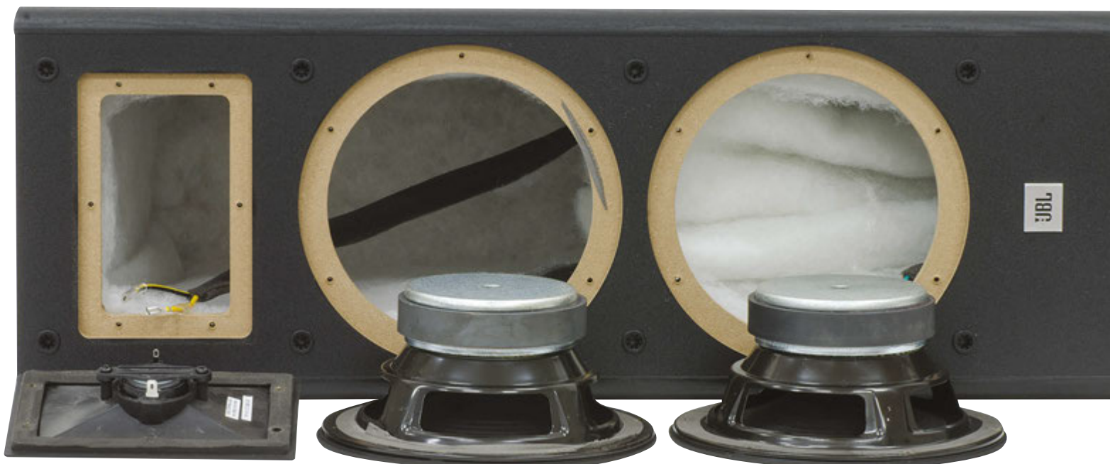
Il diffusore smontato. Notare la coibentazione che riempie la base del mobile e la guaina in foam che contiene i cavi di collegamento. I woofer hanno il cestello in lamiera stampata ed i magneti di dimensioni non esaltanti.
