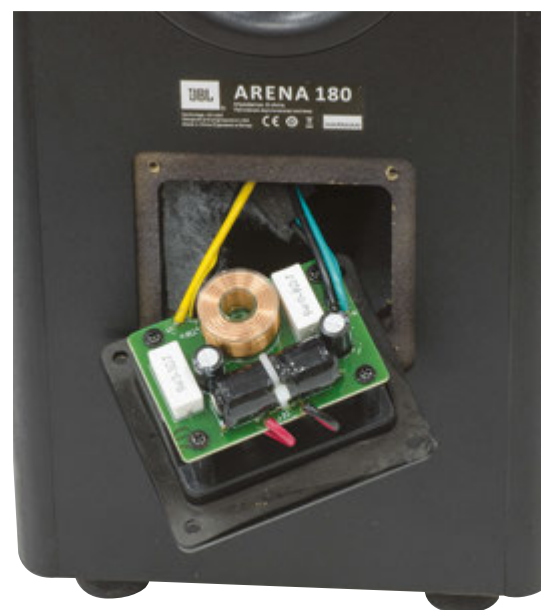
Il filtro crossover fissato sulla vaschetta portacontatti. Si notano i due elettrolitici bipolarizzati e l'induttanza del tweeter avvolta in aria.
